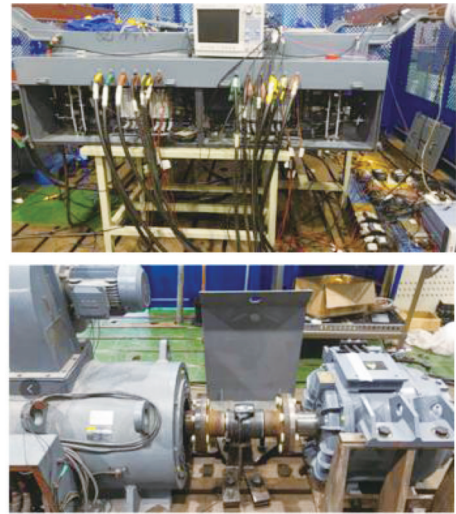
图 12 试验用牵引变流器及永磁同步电机
